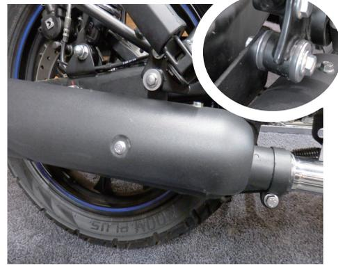
サイレンサー上部の固定箇所を仮止めします。固定には純正のボルト類を再使用します。サイレンサーバンドもある程度締め込んでおきます。
