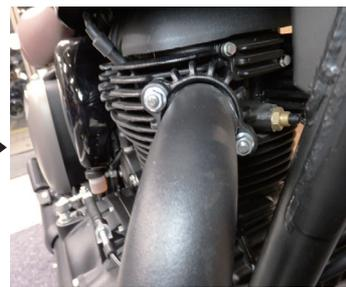
純正パイプをエンジンに固定しているフランジ部のナット2点を取り外し、パイプをゆっくりと車体から取り外します。(ナットはあとで再使用)
