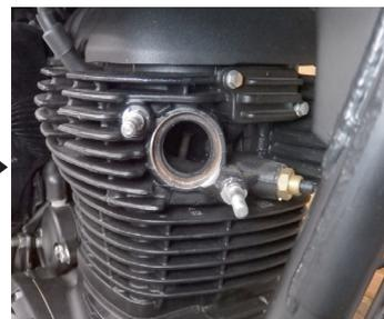
排気ポートのエキゾーストガスケットを新品に交換します。(車種専用サイズのもの別途お買い求め下さい。)
