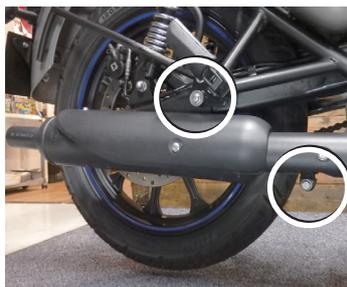
サイレンサーを固定している2ヶ所を緩め、サイレンサーボディをエキゾーストパイプから抜き取ります。(ボルト類はあとで再使用)
