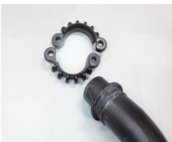
半割り型フランジを分解しておきます。固着している時はプラスチックハンマーなどで合わせ面を叩くと分解できます。
