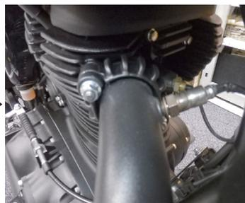
排気ガスセンサーを取り外します。(配線に無理な力をかけて断線しない様に注意!センサーはあとでPOWERBOXパイプに取り付けます。)
