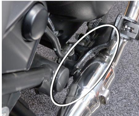
車体各部との隙間を確認しながら必要に応じて位置を調整します。特に転倒歴のある車輛などはフレームやスイングアームとの隙間をよく確認して下さい。
