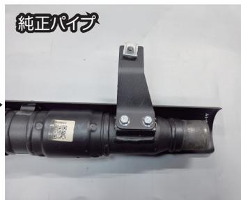
純正パイプに固定されている板状のステーをPOWERBOXパイプに移植します。(ボルト、クリップ型ナットは再使用)
