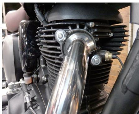
フランジ部の固定には純正のナットを再使用します。
