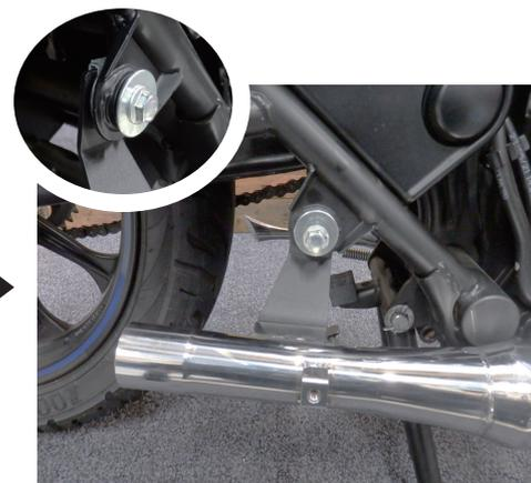
純正パイプの時と同じ様にステーをフレームに仮止めます。固定には純正のボルト類を再使用します。
