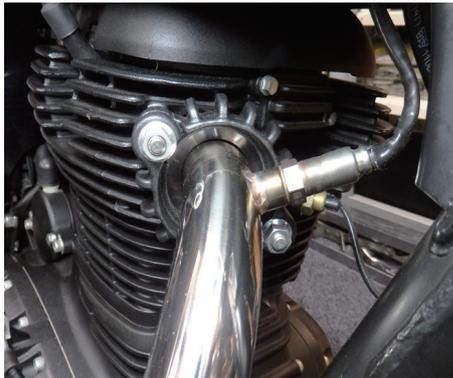
排気ガスセンサーをPOWERBOXパイプに取り付けます。配線を傷めない様に注意しながら組み付け、本締め固定します。
