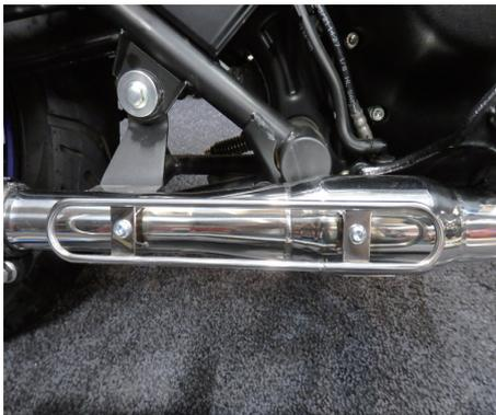
付属のプロテクターをPOWERBOXパイプに取り付けます。付属のボタンボルトを使用して固定します。
