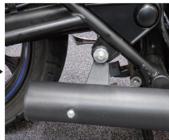
純正パイプをフレームに固定している箇所を緩め、ボルトを抜き取ります。(ボルト類はあとで再使用)
